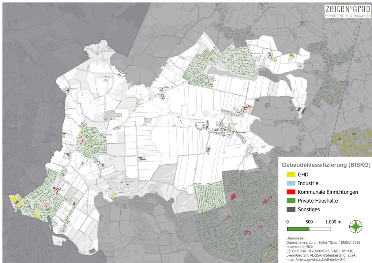
Abbildung 9: Kartografische und gebäudescharfe Darstellung der Gebäudestruktur in der Gemeinde Ammersbek entsprechend des BSKO-Standards Bezugsjahr 2024, Quelle: ENEKA).
